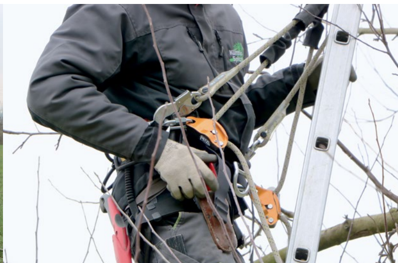
Die Positionssicherung ist von der SUVA vorgeschrieben.
