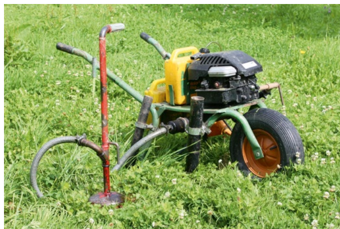
Die „Mausmaschine“: Mit ihr werden die Mäuse in den Gängen vergast.
